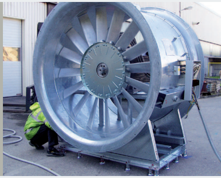
Antivibrační úprava pro ventilátory
